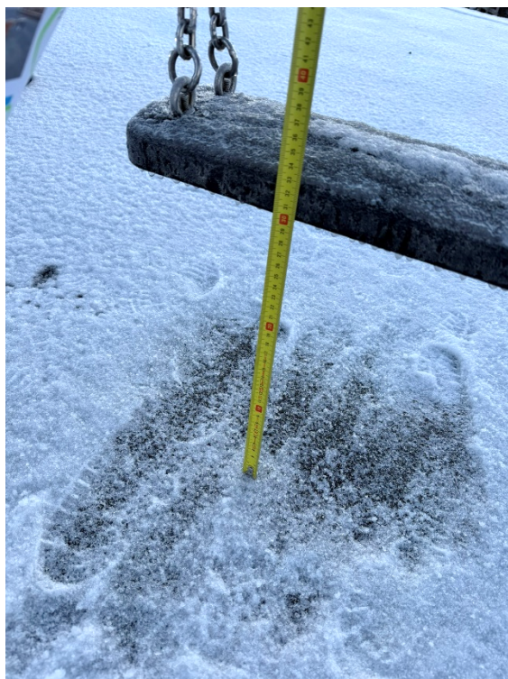
Mynd 3. Hæð undir setu ófullnægjandi (30 cm)
